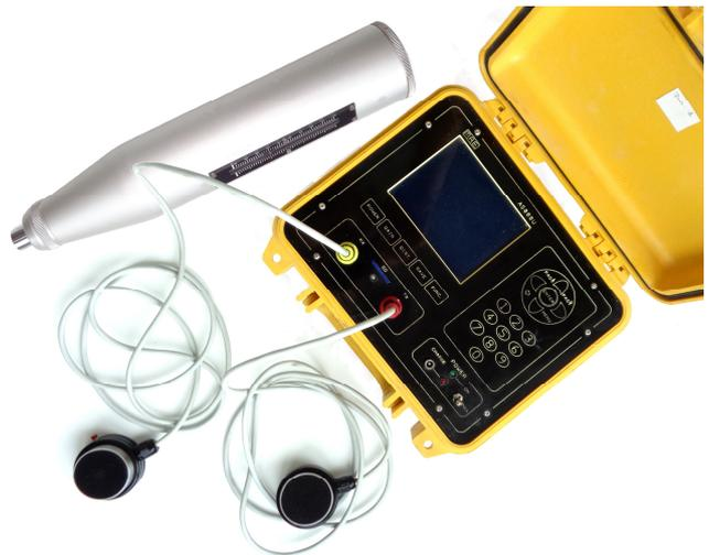
Fig.2. La strumentazione utilizzata per le prove SonReb: sclerometro e centralina per ultrasuoni (con le relative sonde).
