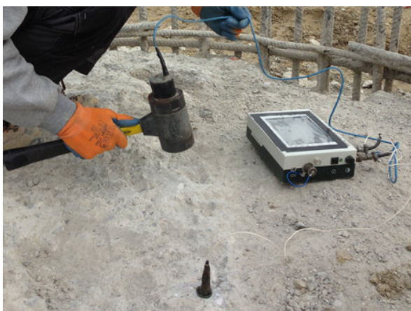
Figura 1: particolare della strumentazione impiegata durante l'esecuzione della prova: martello strumentato, accelerometro e centralina di acquisizione dati.
