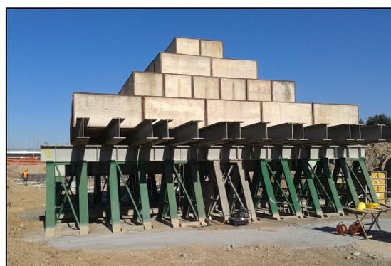
Figura 9: struttura di contrasto realizzata in blocchi di cemento utilizzata per l'esecuzione della prova di carico statica.
