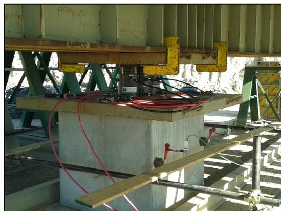
Figura 8: particolare dei cilindri idraulici e dei comparatori elettronici impiegati per la misura degli abbassamenti.
