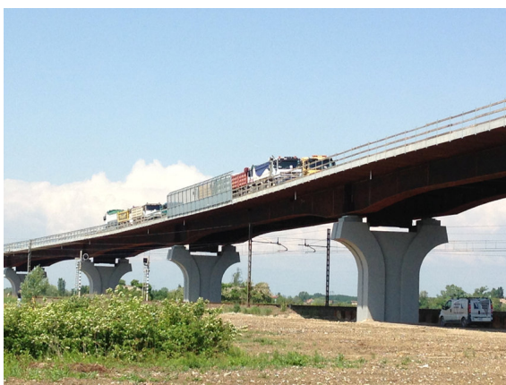
Figura 18: configurazione per la prova di carico n°2.
