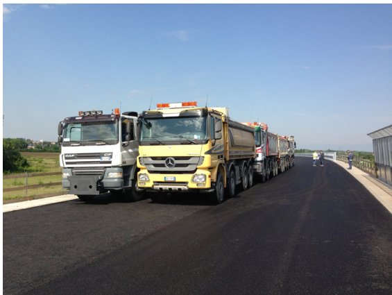
Figura 17: configurazione per la prova di carico n°1.
