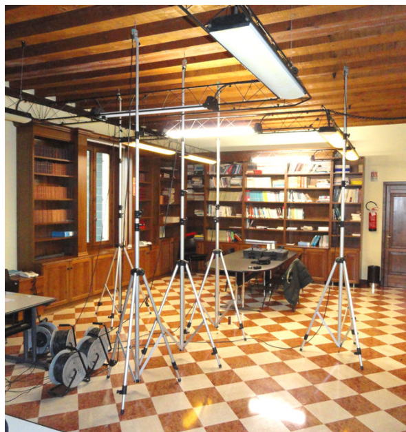
Figura 2: i sensori posizionati al piano inferiore rispetto a quello dove viene allestita la vasca.
